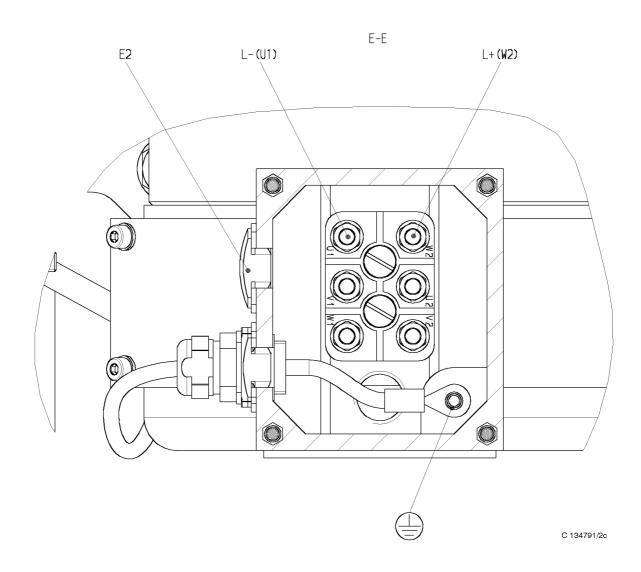
Е2 Отверстие для ввода кабеля (двигатель)
